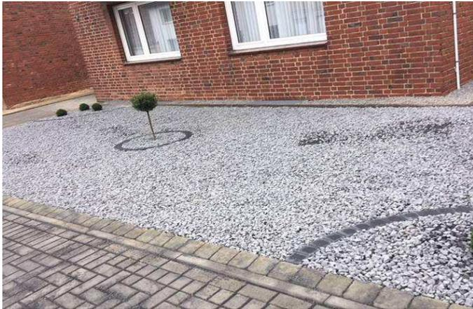
Wird ein Vlies oder eine Folie eingebaut, gilt die Fläche als versiegelt. Auch die Bodenfruchtbarkeit wird reduziert, da die schweren Steine die Bildung von Bodenluft verhindern und das Bodenleben unmöglich machen. Für Pflanzen und Tiere bieten diese Flächen kaum Lebensraum. Die Steine heizen sich auf und generieren so zusätzliche Hitze anstatt wie Pflanzen durch Verdunstung zu einer Befeuchtung und Kühlung der Luft beizutragen. Dies ist vor allem mit Sicht auf den Klimawandel
